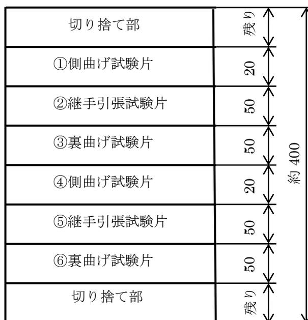
刻印は，継手引張試験片，側曲げ試験片については表面に，裏曲げ試験片については裏面に打刻する。
