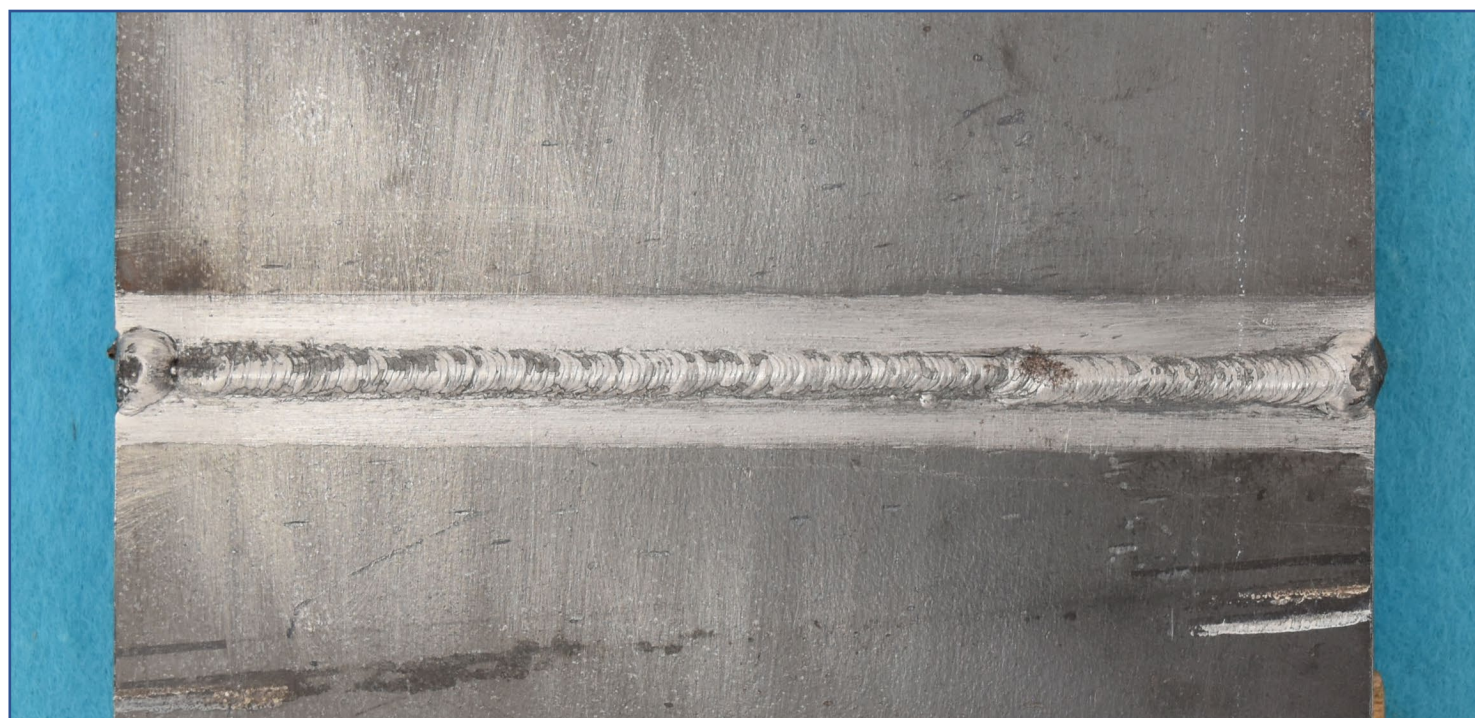
手溶接(中板)裏面【例 4】
