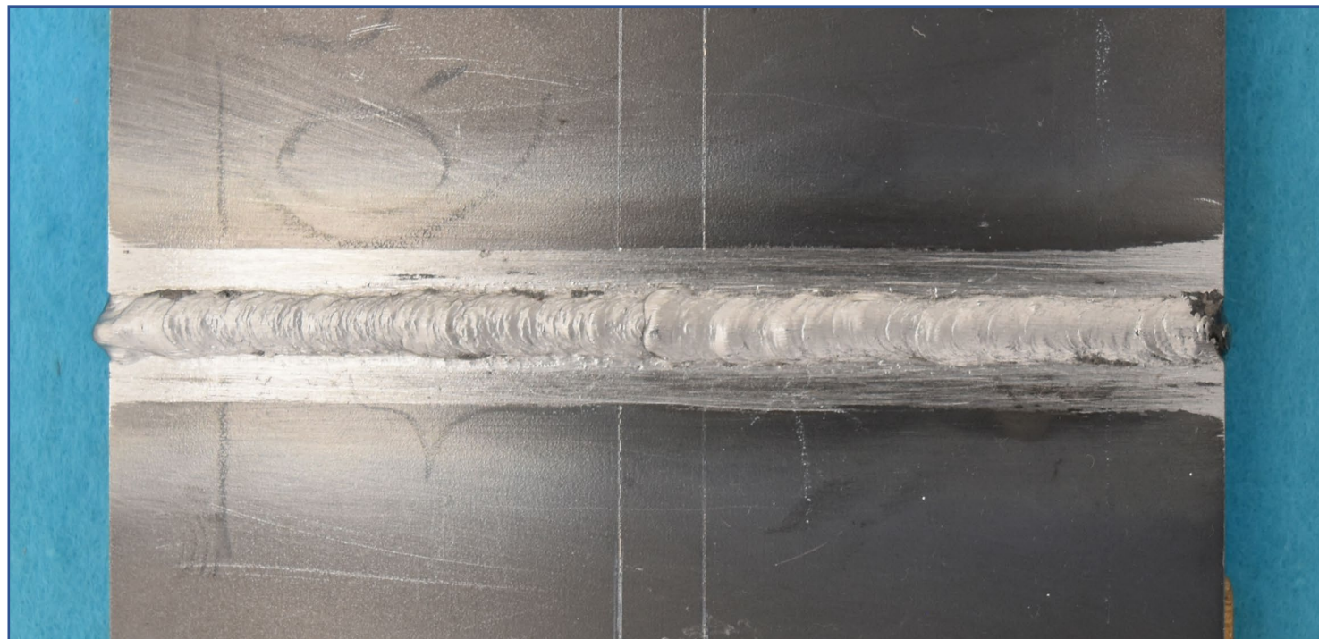
手溶接(薄板)表面【例 2】
