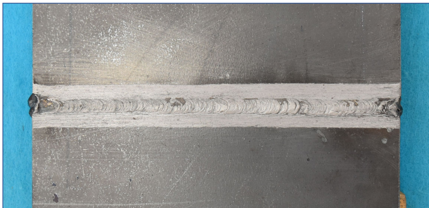
手溶接(中板)裏面【例 1】
