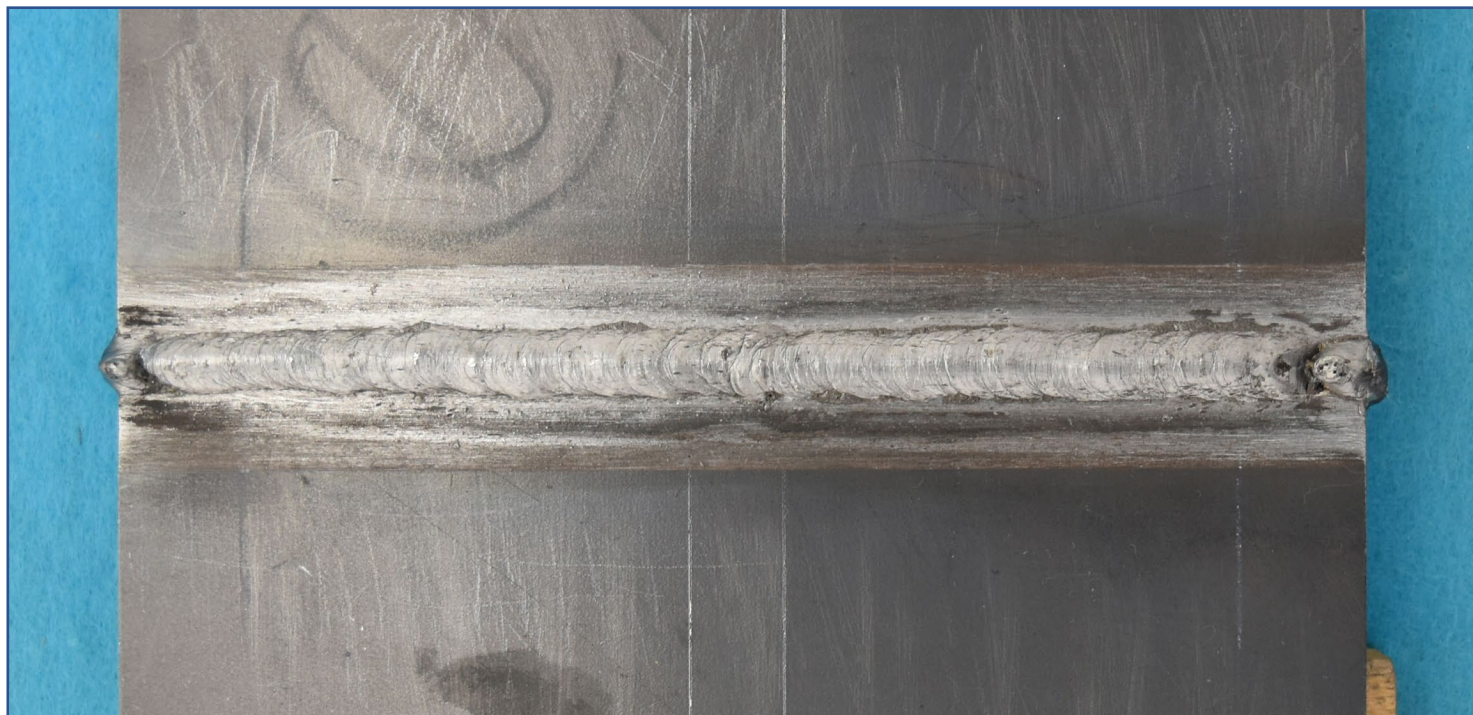
手溶接(薄板)表面【例 5】
