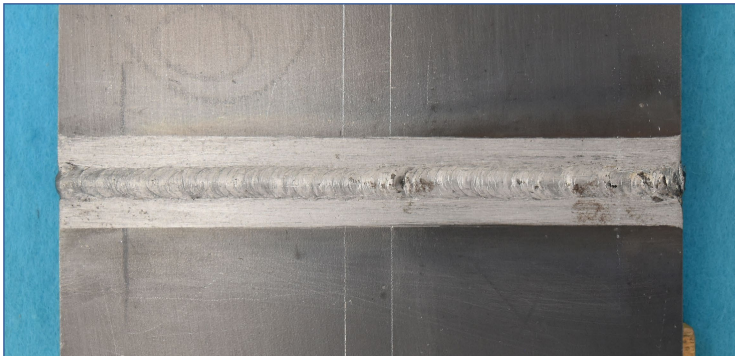
手溶接(薄板)表面【例 1】
