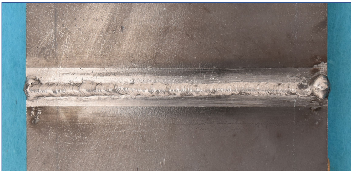
手溶接(中板)裏面【例 5】
