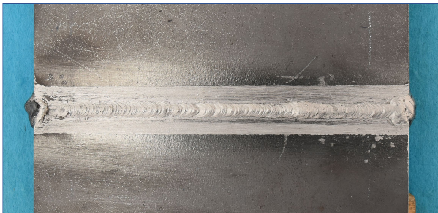
手溶接(中板)裏面【例 2】
