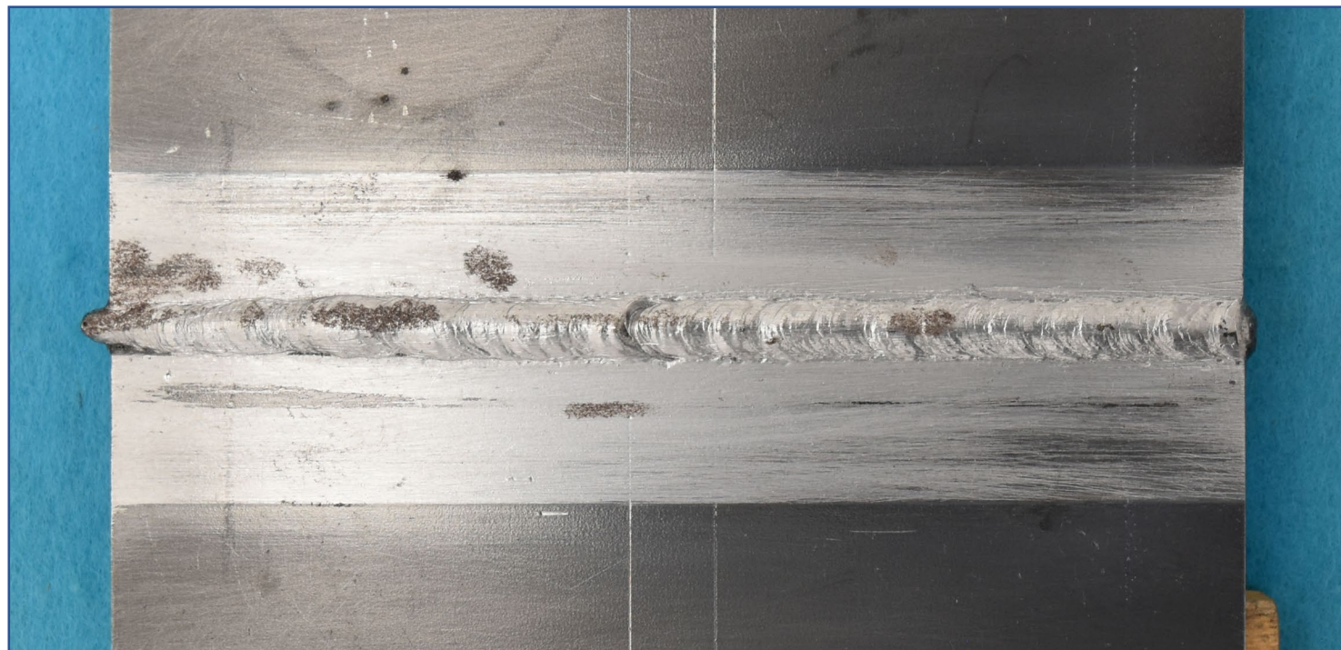
手溶接(薄板)表面【例 3】
