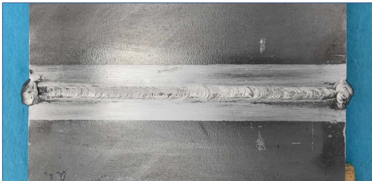
手溶接(中板)裏面【例 3】
