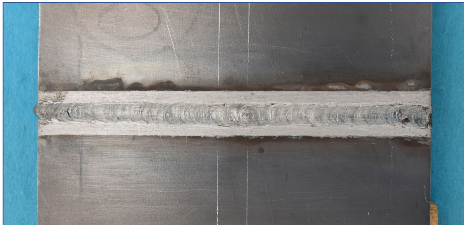
手溶接(薄板)表面【例 4】
