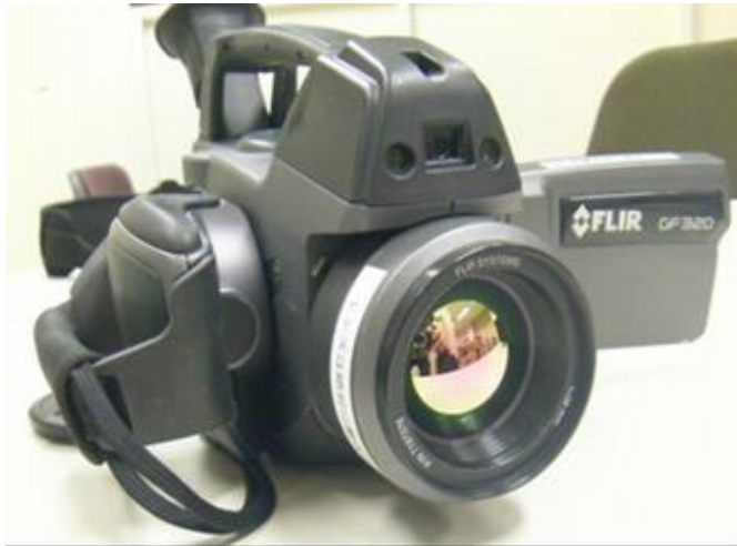
ガス漏れ検知用赤外線 (OGI) カメラ
