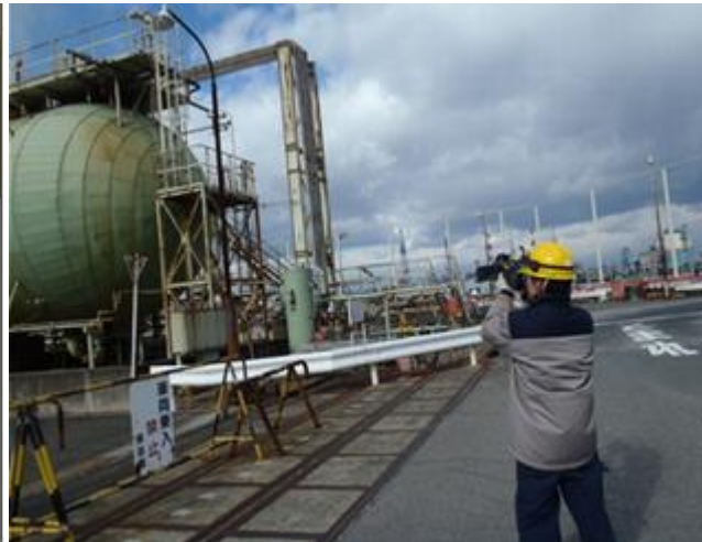
ガス漏れ検知用赤外線 (OGI) カメラ
