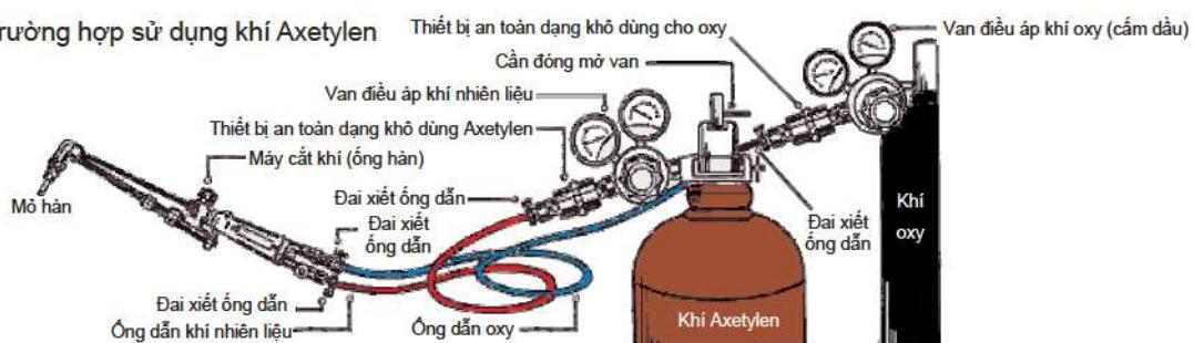
Lưu ý 2: Hãy cài đặt thiết bị chống cháy ngược (van an toàn dạng khô) cho thiết bị tiêu thụ khí Axetylen dùng để hàn hoặc cắt nhiệt. (Mục 13 Khoản 1 Điều 60 Quy định chung về an toàn khí áp suất cao và Tiêu chuẩn mô tả 79, Hướng dẫn kỹ thuật của Phòng nghiên cứu tổng hợp vệ sinh an toàn lao động (JNOSH-TR-48:2017))
