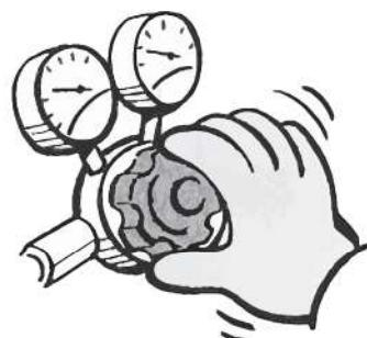
Xác nhận xem khi điều khiển cần điều áp thì có tăng lên mức áp suất sử dụng cao nhất không.
