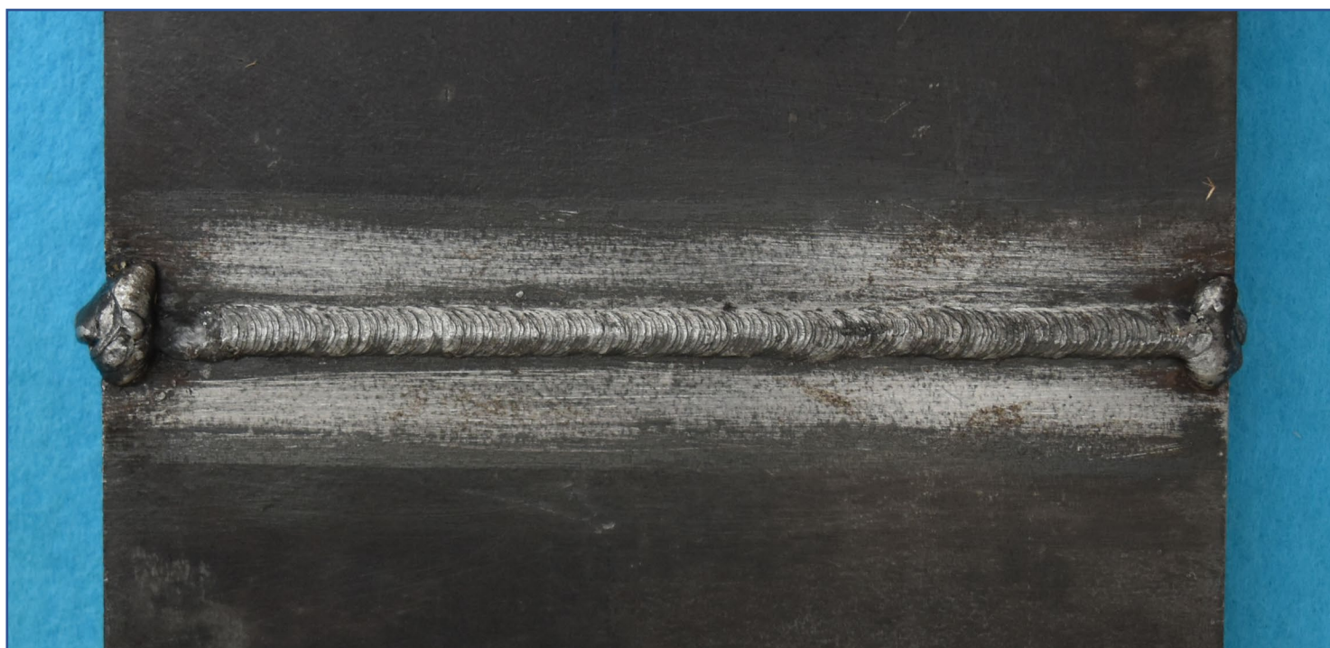
手溶接(中板)裏面【例 1】
