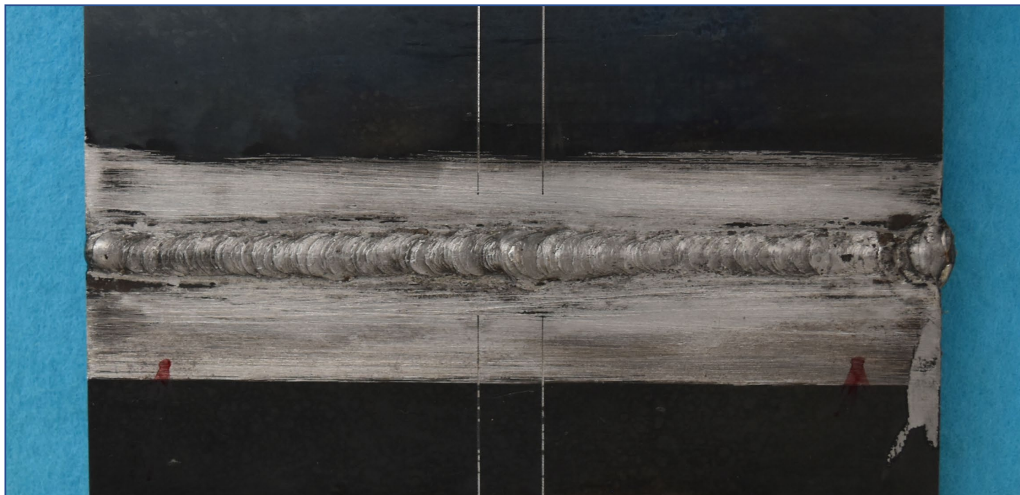
手溶接(薄板)表面【例 1】
