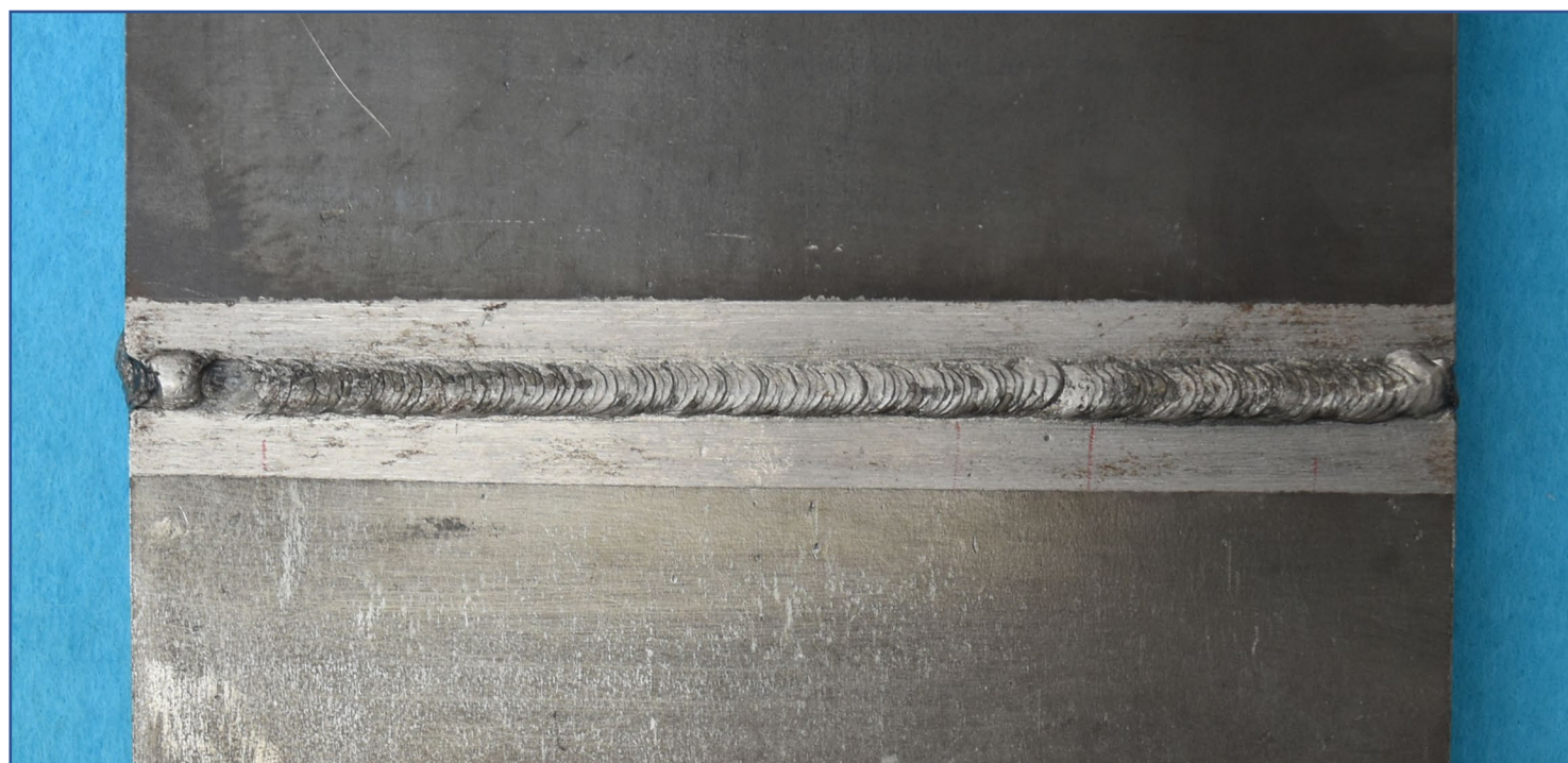
手溶接(中板)裏面【例 2】
