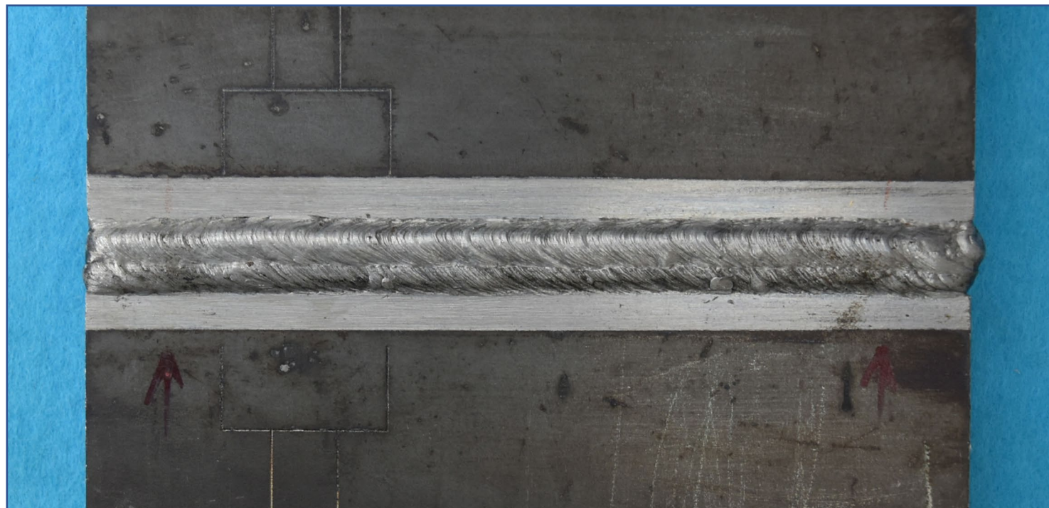
手溶接(中板)表面【例 2】
