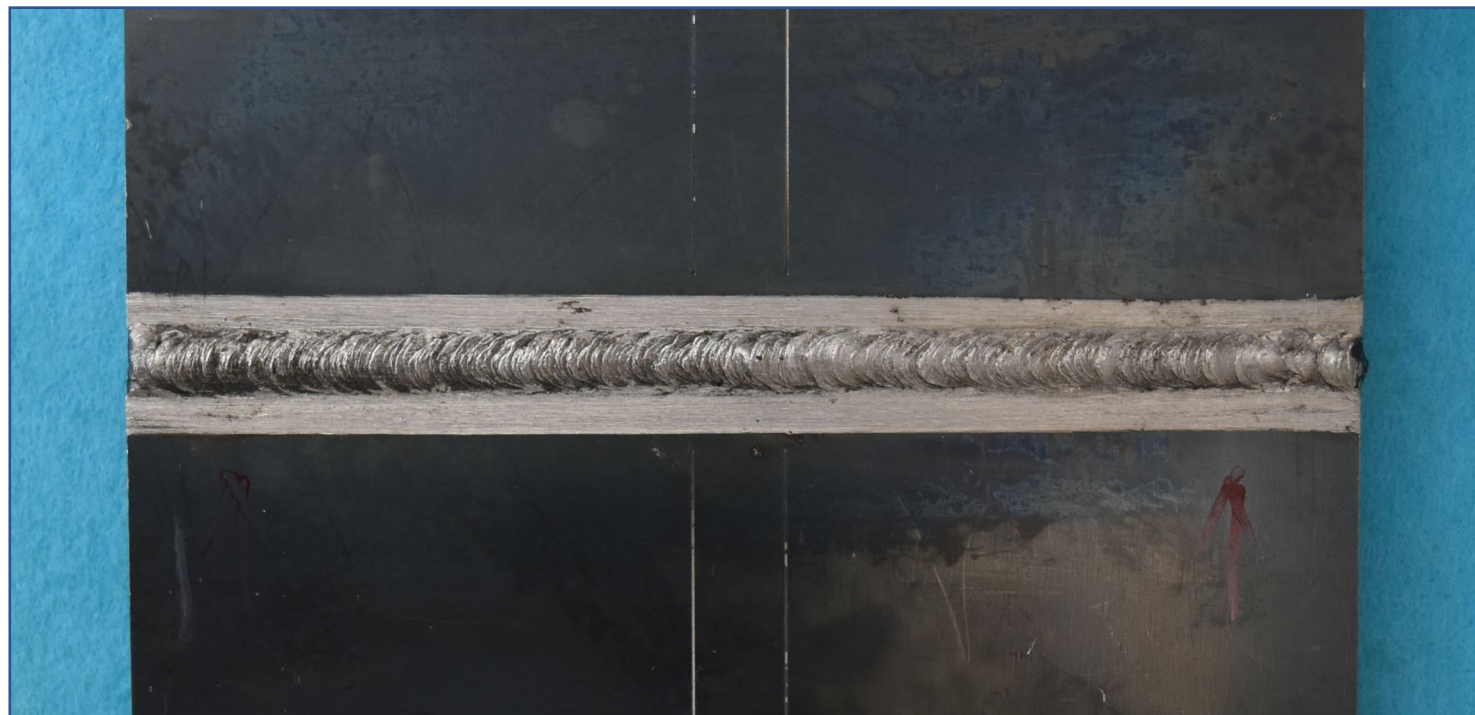
手溶接(薄板)表面【例 2】
