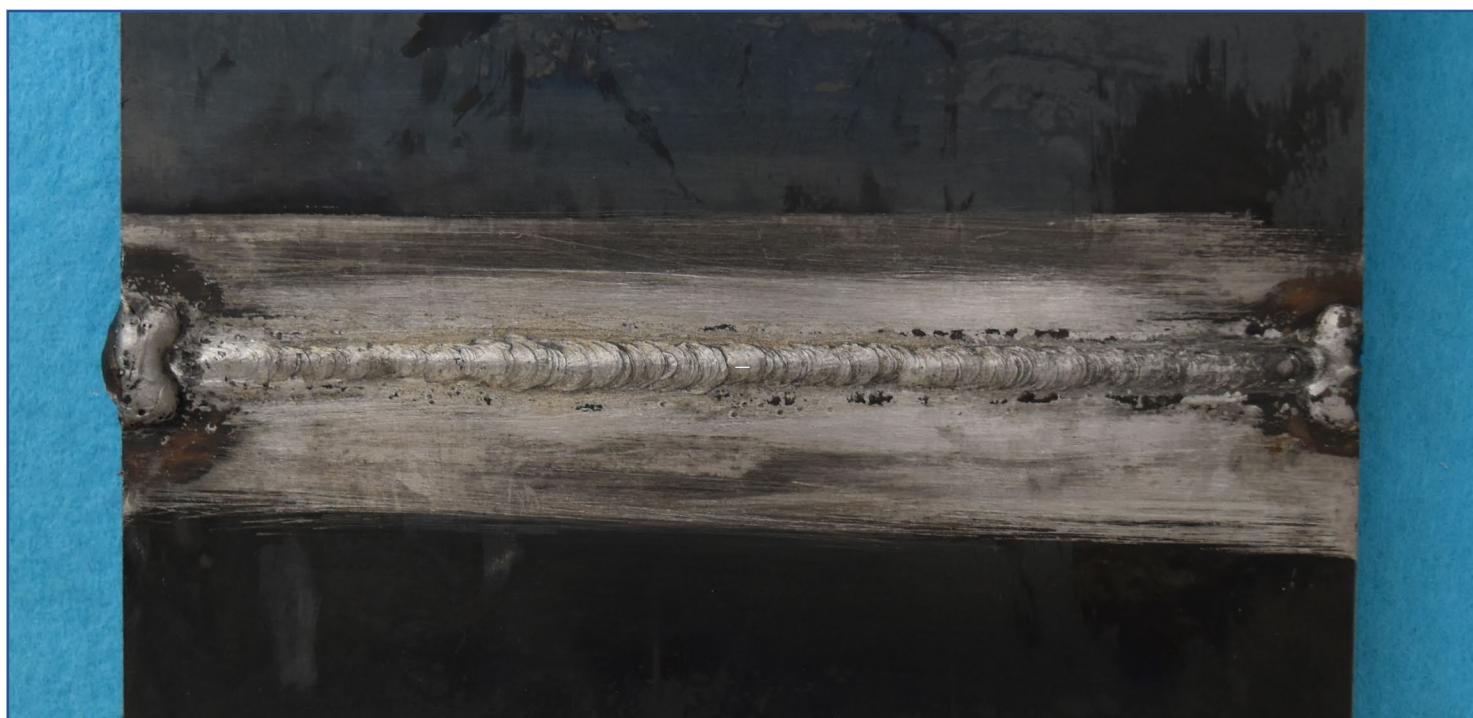
手溶接(薄板)裏面【例 1】
