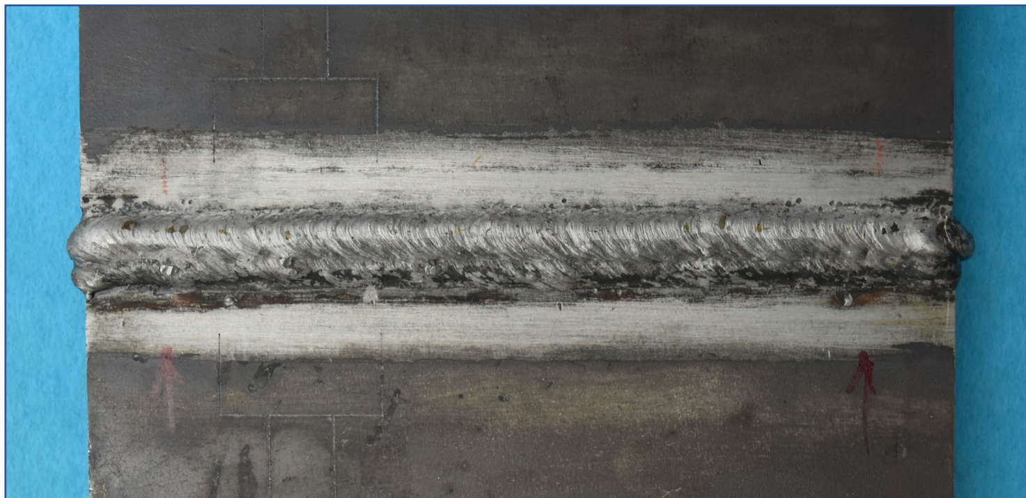
手溶接(中板)表面【例 1】
