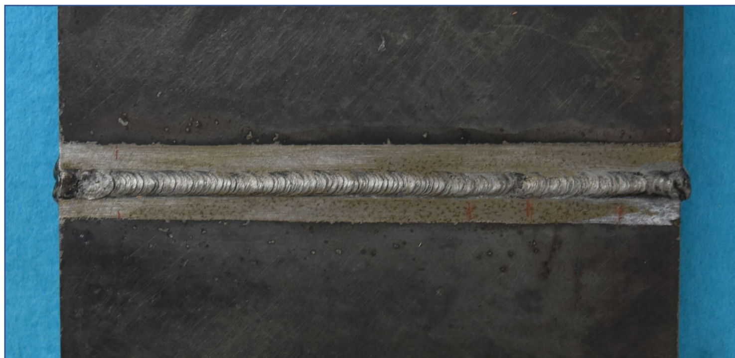
手溶接(中板)裏面【例 6】
