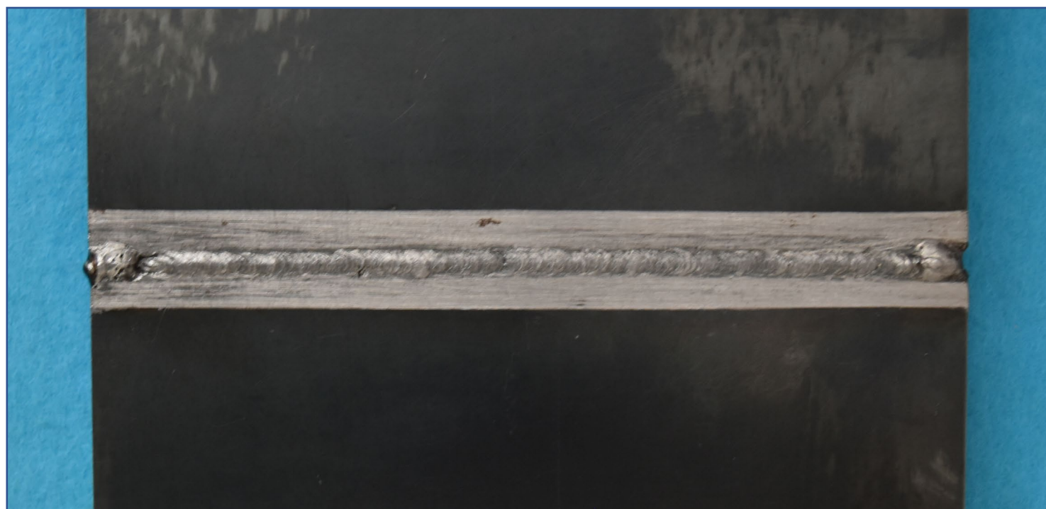
手溶接(薄板)裏面【例 2】
