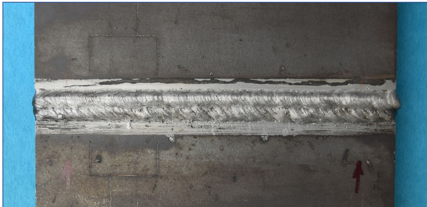
手溶接(中板)表面【例 3】
