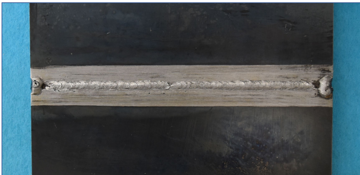
手溶接(薄板)裏面【例 5】
