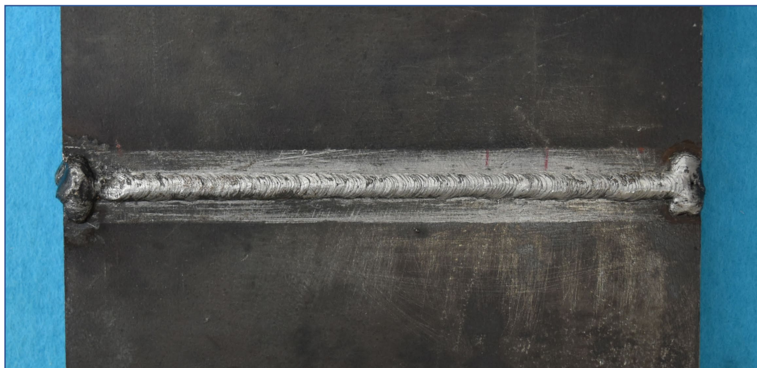
手溶接(中板)裏面【例 3】
