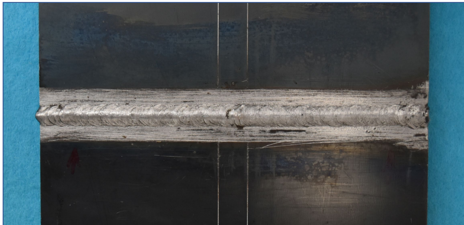
手溶接(薄板)表面【例 3】
