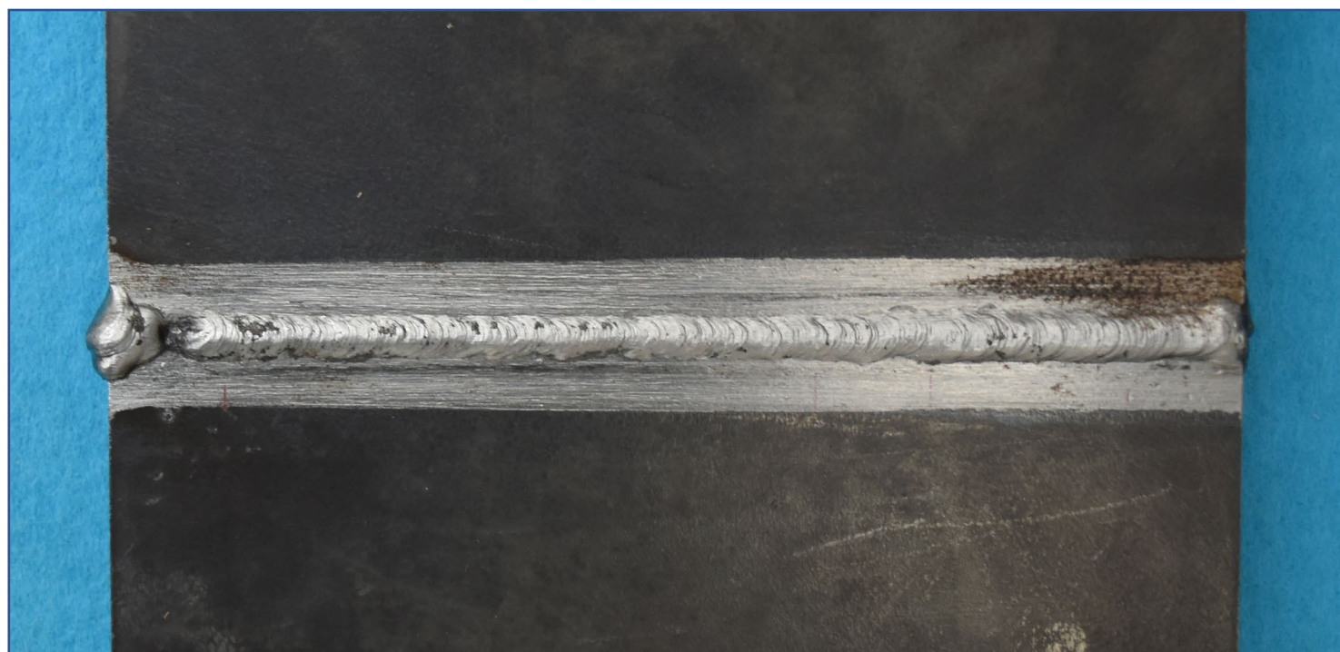
手溶接(中板)裏面【例 4】
