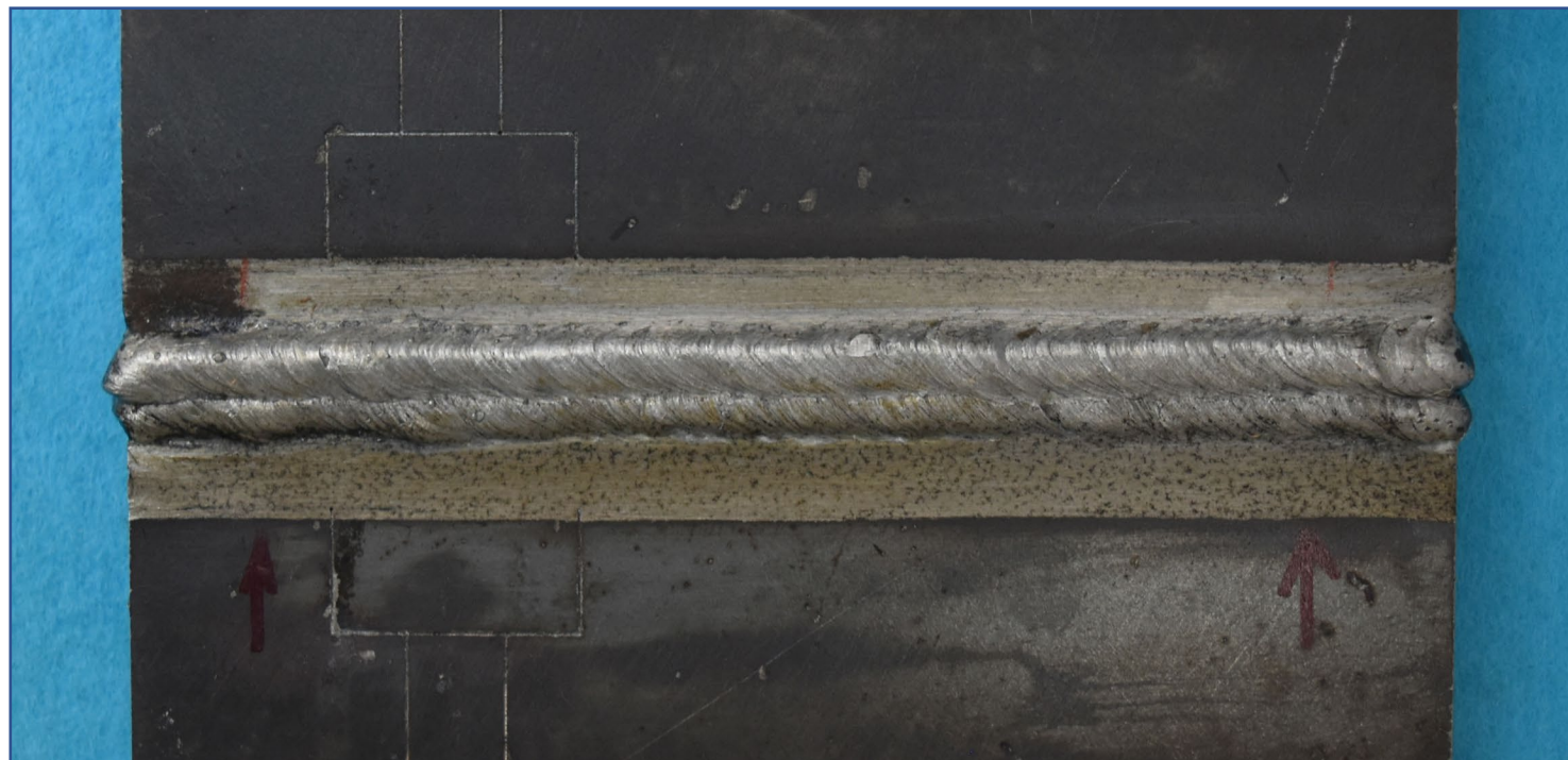
手溶接(中板)表面【例 6】
