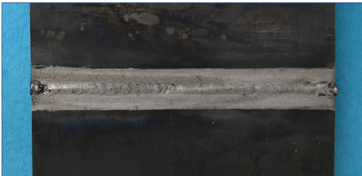
手溶接(薄板)裏面【例 6】
