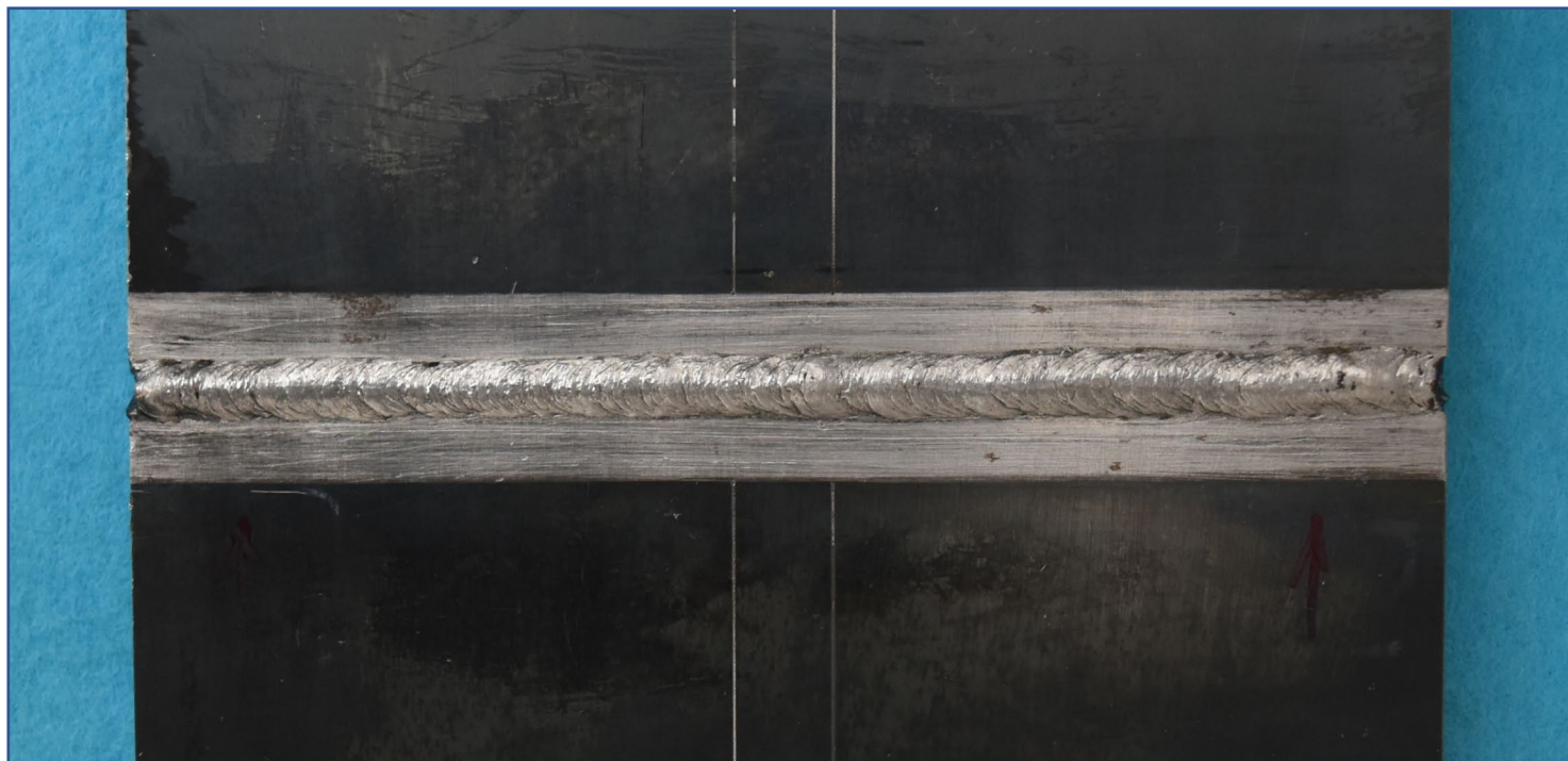
手溶接(薄板)表面【例 5】
