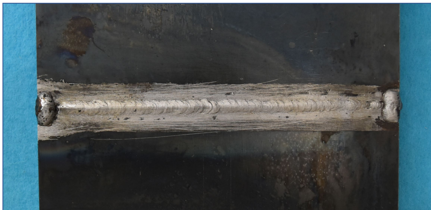
手溶接(薄板)裏面【例 3】
