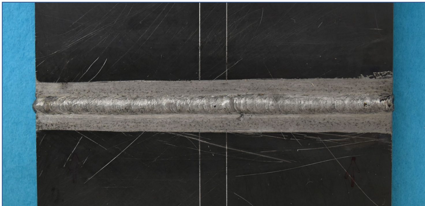
手溶接(薄板)表面【例 6】
