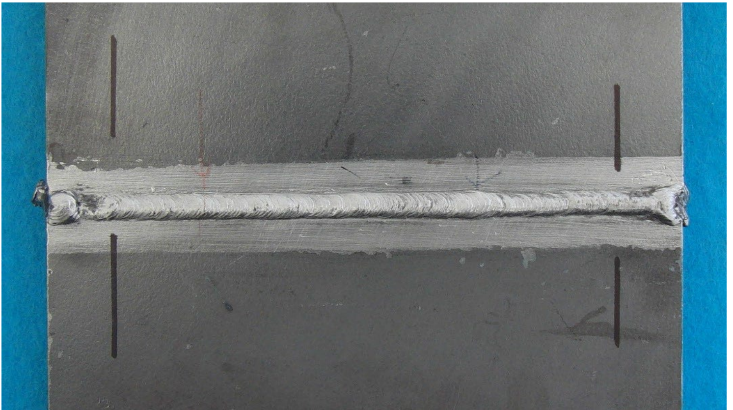
手溶接(中板)裏面【例7】
