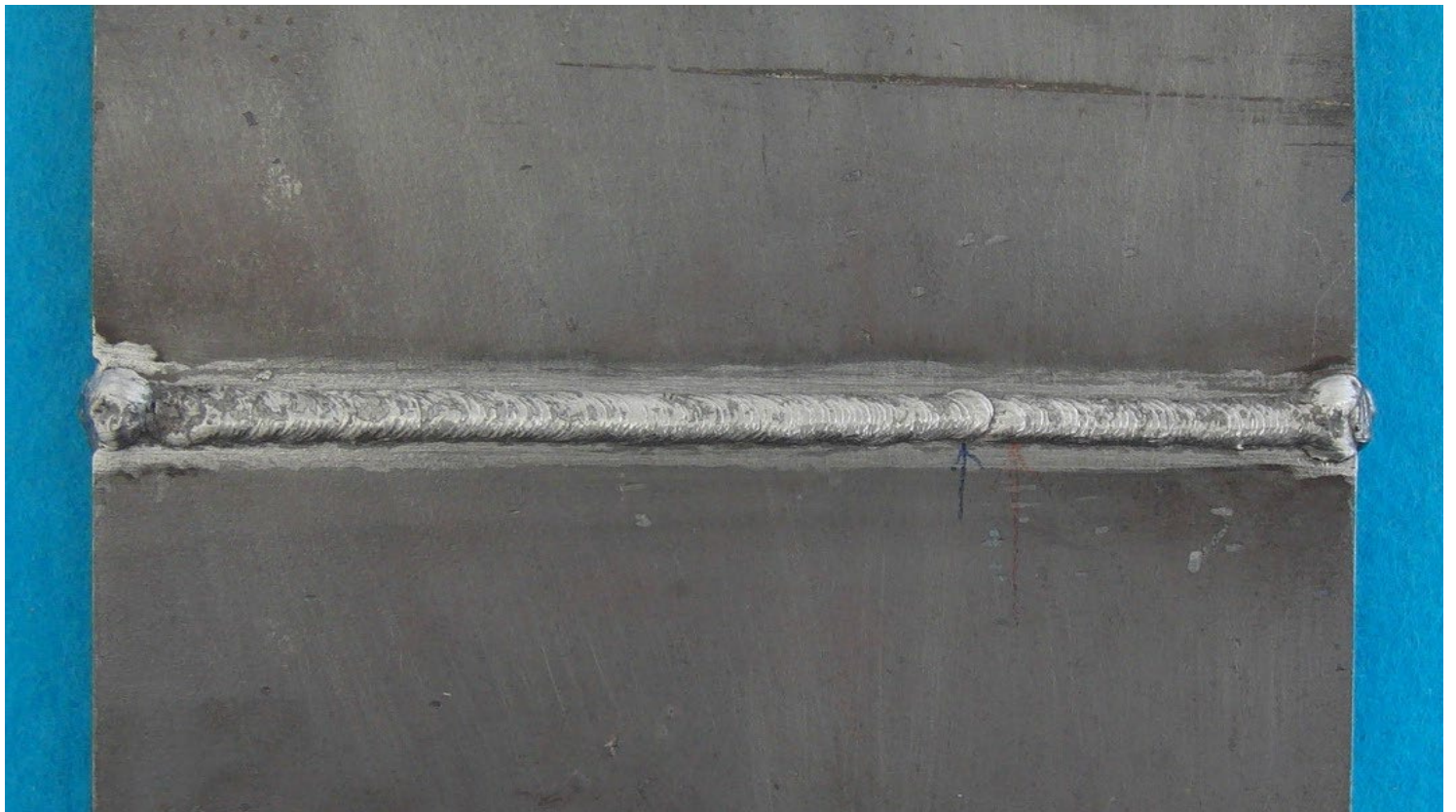
手溶接(中板)裏面【例6】
