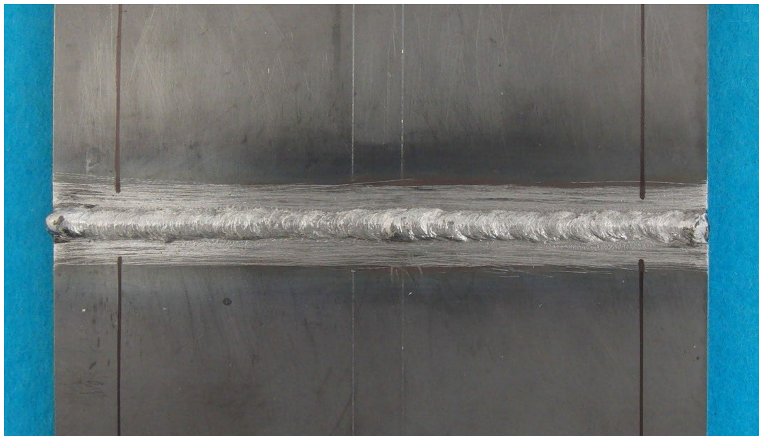
手溶接(薄板)表面【例7】
