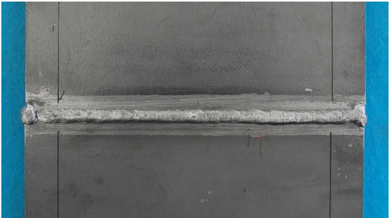
手溶接(中板)裏面【例4】
