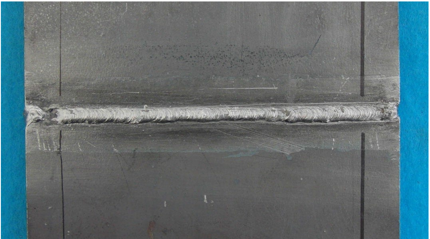
手溶接(中板)裏面【例1】
