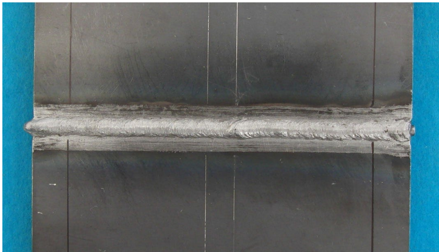
手溶接(薄板)表面【例2】
