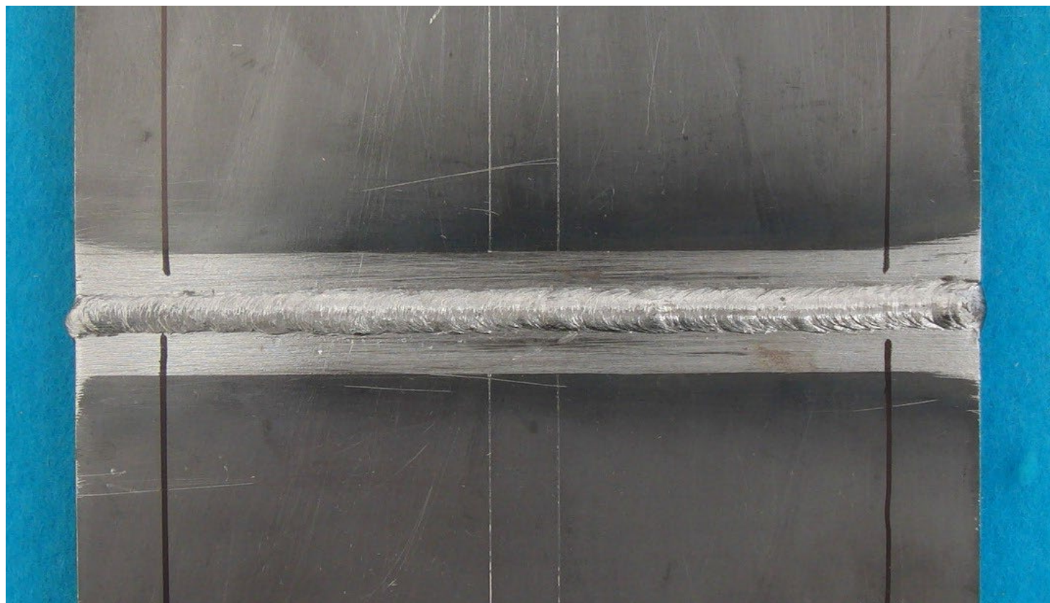
手溶接(薄板)表面【例5】
