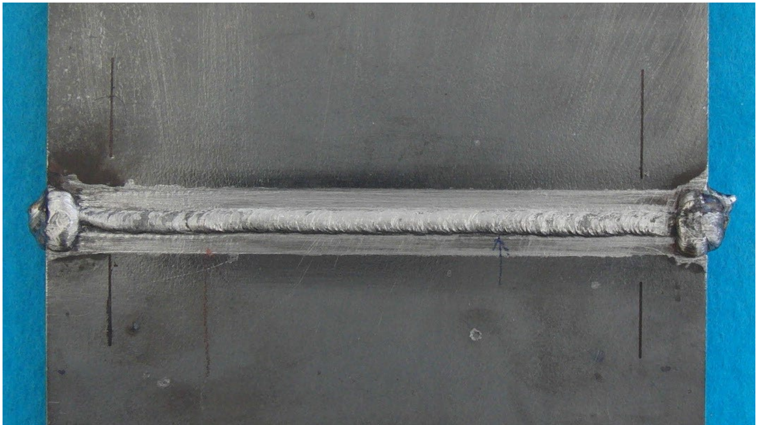
手溶接(中板)裏面【例8】
