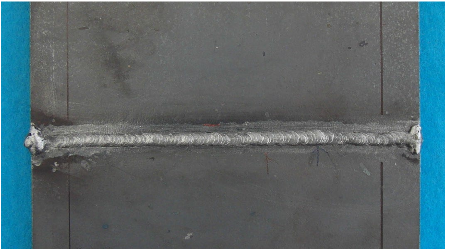
手溶接(中板)裏面【例2】
