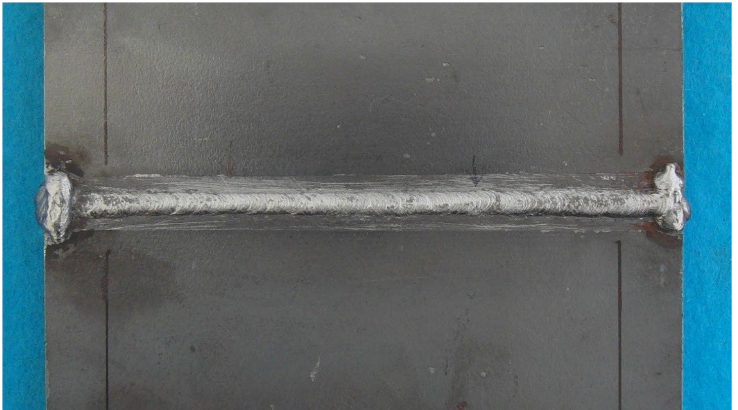
手溶接(中板)裏面【例3】
