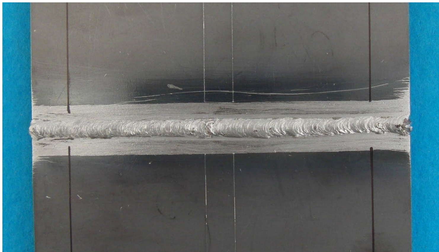
手溶接(薄板)表面【例8】
